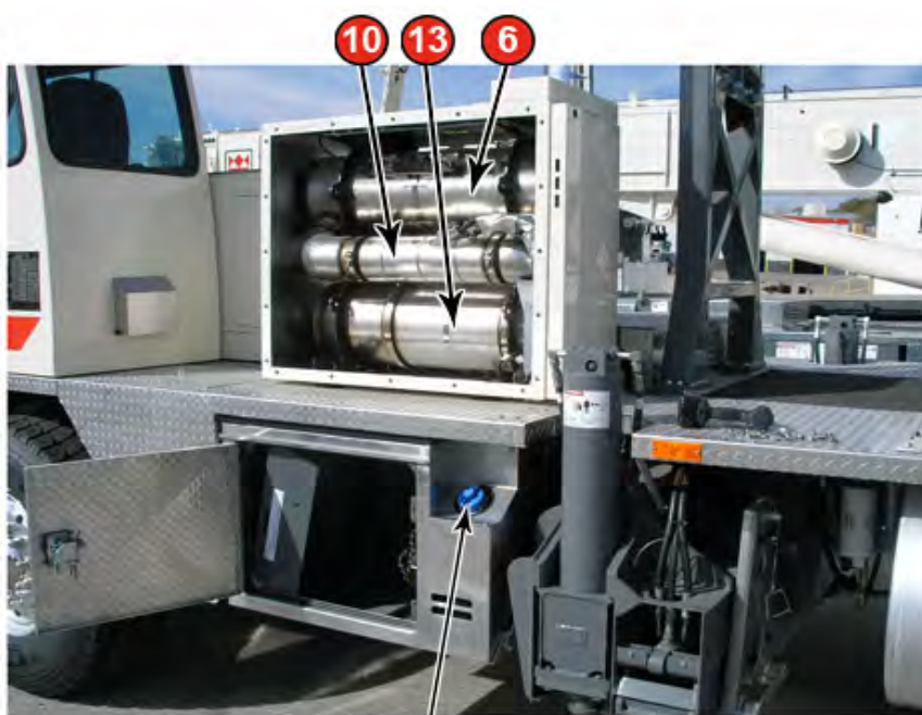
DEF (UREA) FILL TANK
